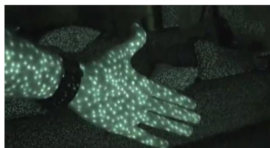
图 2. Kinect 发出的激光散斑
