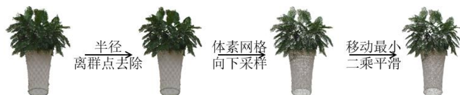
图 6.1.1. 三维点云后处理流程
