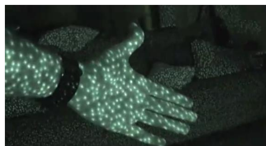
图 1.1.2. Kinect 红外投影机发出的激光散斑
