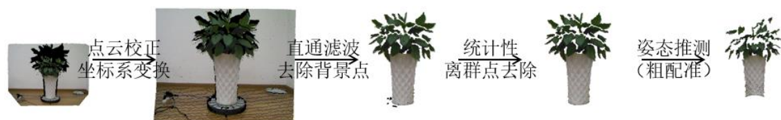
图 4.1.2. 三维点云预处理流程
