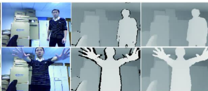
图 15. Kinect 深度图像修复结果
