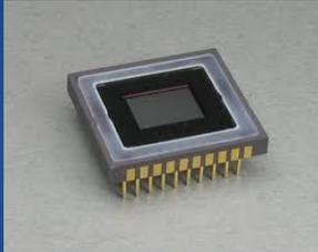
CCD or CMOS sensor array
