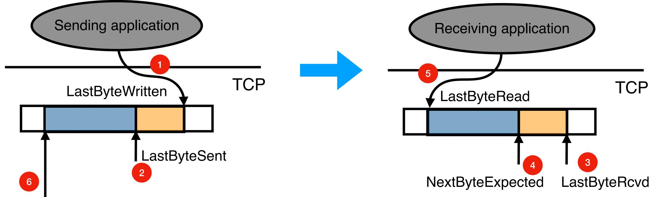
• ILastByteWritten - LastByteAckedl <= MaxSendBuffer
